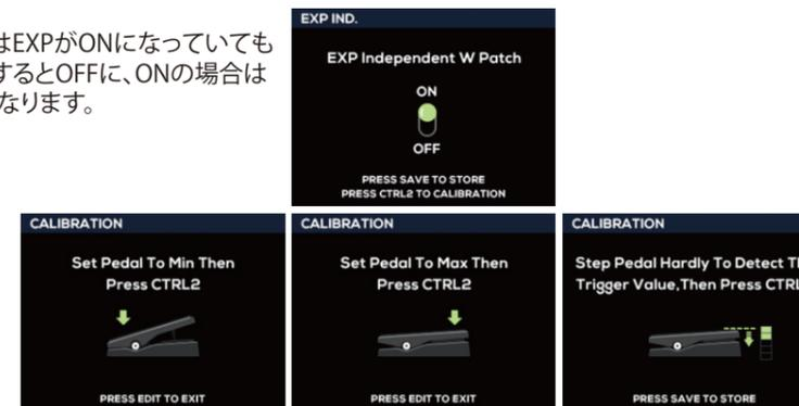
EXPペダルのキャリブレーション (ペダルの可動域、ON/OFF位置の調整) を行う際は、EXP SETUP画面でCTRLフットスイッチを押し、画面の説明に沿って実行してください。
