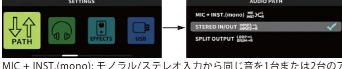
MIC + INST.(mono): モノラル/ステレオ入力から同じ音を1台または2台のアンプへ出力します。
